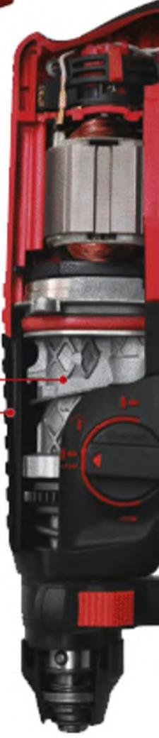
Корпус редуктора из литого алюминия
